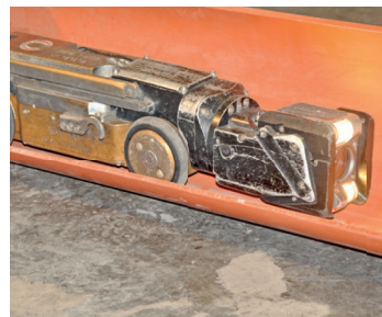
Indirekte Kanalinspektion mit einer Kanalfernsehkamera
