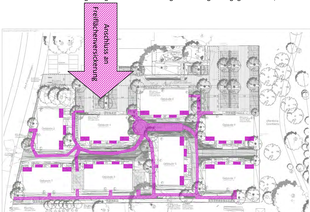
Abbildung 2: Übersicht der über die Flächenversickerung entwässerten Bereiche
